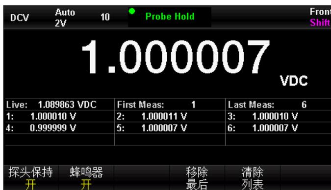
图 3-10 DCV Hold 测量界面
