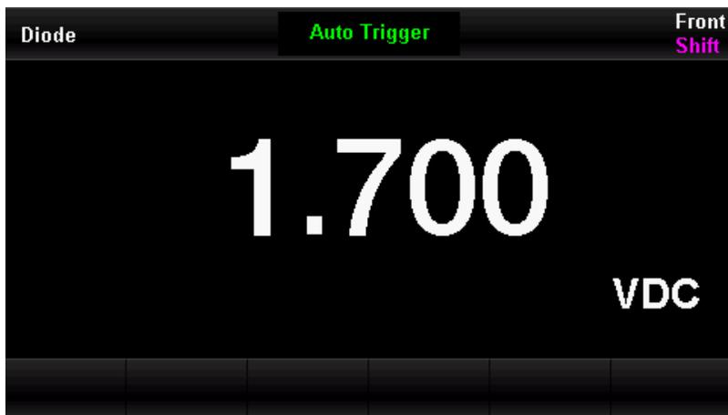
图 2-8 二极管导通电压测量
